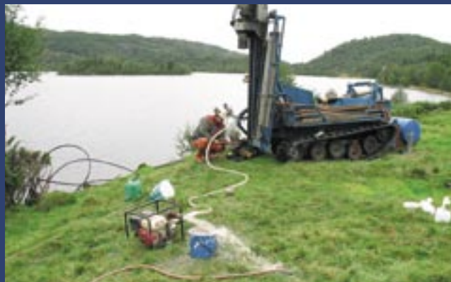
Boring på en sand og grusforekomst for vurdering av grunnvannsuttak, Gulingen, Suldal. Foto: Asplan Viak AS ©
