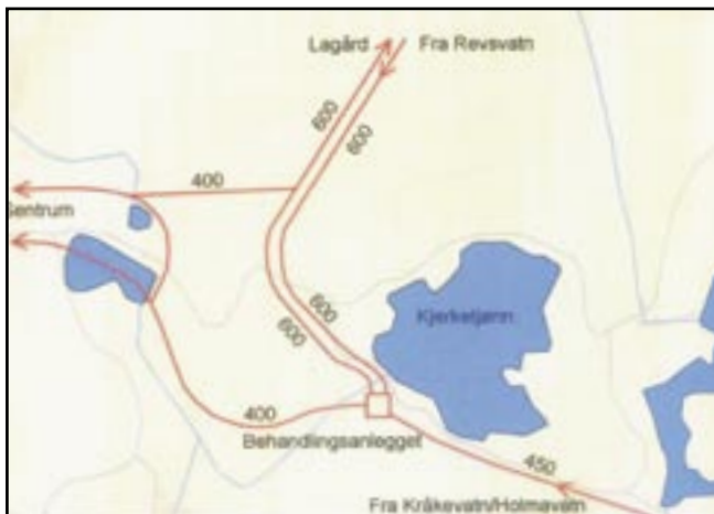
Ledningsanlegg ved nytt planlagt behandlingsanlegg som blir et knutepunkt i systemet
