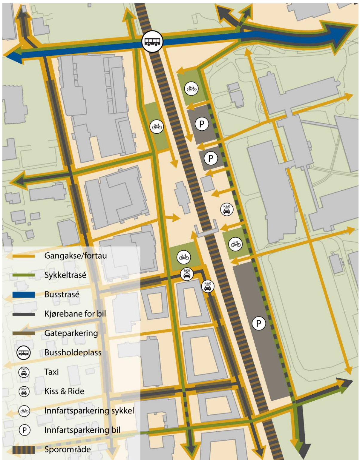
Figur 5.6 Funksjoner og tilgang til fremtidig stasjon.
