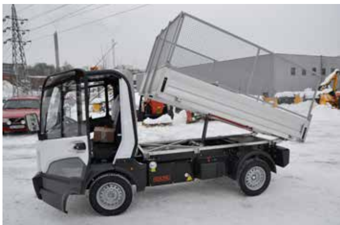
G5 og G3 elektriske kjøretøy med små ytre mål og optimal ergonomi. 1 tonn nyttelast, rekkevidde 171 km, klar for kommunaltekniske oppgaver. Foto: Kjell M. Jacobsen
