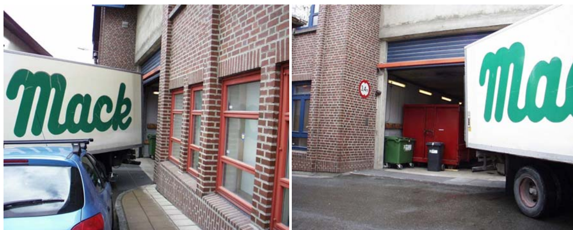
Tromsø. Når varemottaket til et stort kjøpesenter er så lavt at en vanlig distribusjonsbil ikke kommer inn, blir den stående og sperre for øvrig trafikk. I tillegg er varemottaket fylt opp med søppelkomprimator, containere og skrot, så selv en liten varebil hadde ikke kunnet nyttiggjøre seg biloppstillingsplassen i varemottaket.
