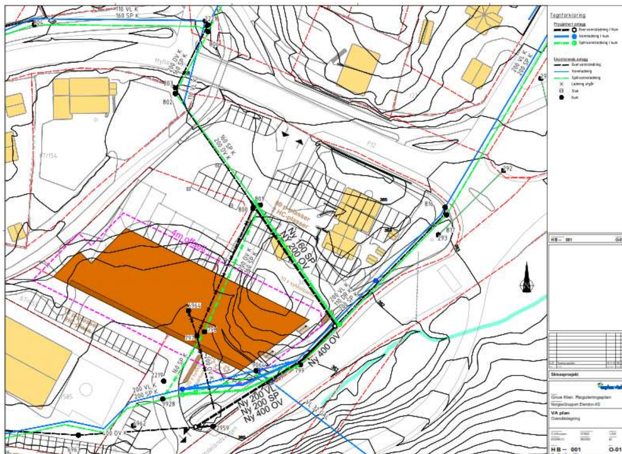
Figur 10. Forslag til omlegging av eksisterende VA-nett.
