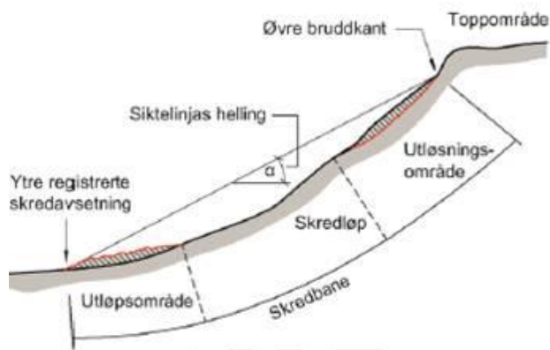
Figur 50. Profil av skredbane med løsningsområde, skredløp og utløpsområde. (Byggdetaljblad 311.136 Løsmasseskred i bratt terreng 2015).
