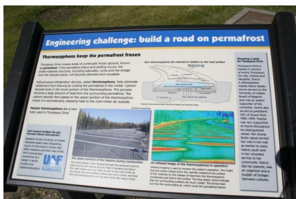
Figur 17. Thermosyphons brukt i vegbygging i Alaska (poster av Professor Douglas Goering, University of Alaska, Fairbanks UAF).
