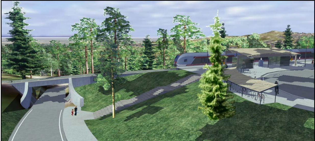
Adkomstveg under jernbane i ny undergang.
