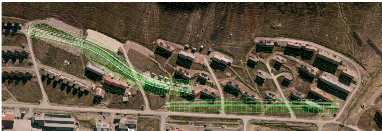
Figur 5-1. Grønne linjer viser høydekurver i vollene, høydeavstand er 1 m. Bakgrunnsfoto: Norsk polarinstitutt.
