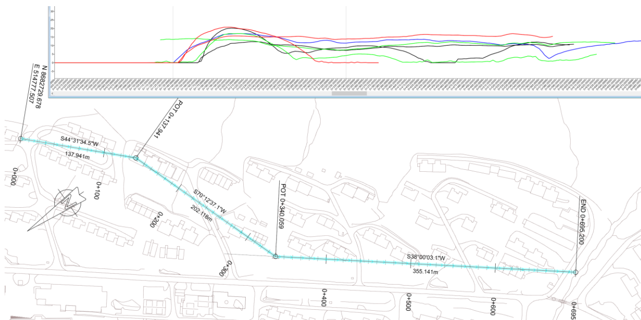
Figur 4-1. Nedre del: Planfiguren viser lyseblå referanselinje. På høyre del ligger linjen omtrent parallell med Hilmar Rekstensvei, avstand er ca. 30 m. Øvre figur: Profil i hastigheter: Svart linje: NGI, Blå linje: NVE, Grønn linje: Skred AS, og Rød linje: UNIS. To loddrette linjer representerer knekkpunkter i referanselinjen. Høydeskalaen har 5 m/s hopp, null ved den røde horisontale linjen.
