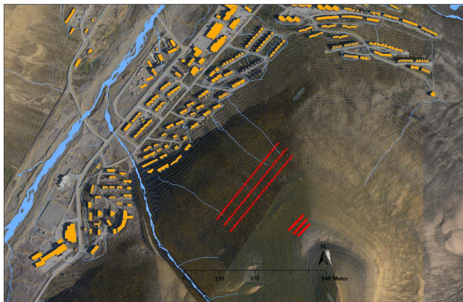
Figur 14: Støtteforbygninger kan plasseres i øvre og midtre løsneområde. Midtre del av fjellsiden er svært aktiv og etablering av støtteforbygninger her er ugunstig.
