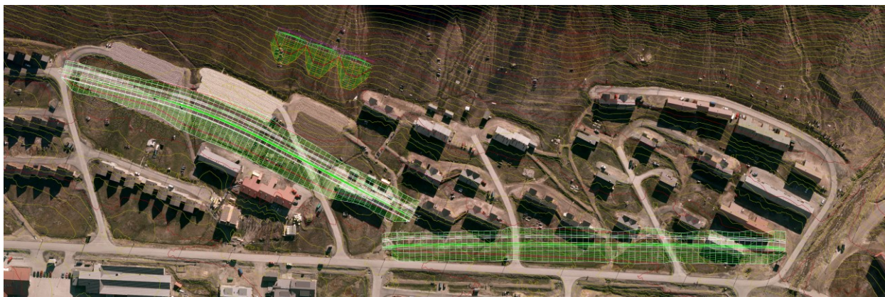
Figur 5-3. Alt. 3. Grønne linjer viser høydekurver i vollene og kjeglene, høydeavstand er 1 m. Bakgrunnsfoto: Norsk polarinstitutt.
