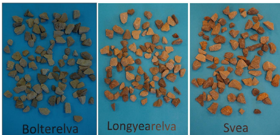
Foto nr. 1: Bildet er hentet fra laborierapporten til SINTEF, og viser nedknust tilslagsmateriale i fraksjonen 8-16 mm fra Bolterelva, Longyearelva og Svea.
