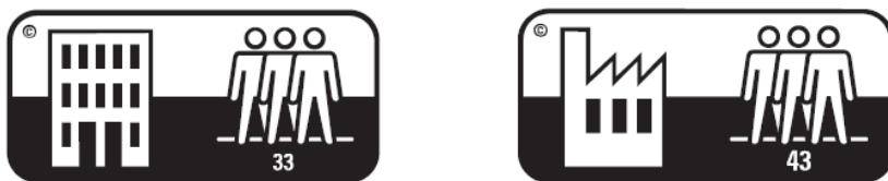
Figur 3-3: Eksempel på klassifisering av halvharde gulvbelegg etter NS-EN ISO 10874. Offentlige miljøer til venstre og industri til høyre
