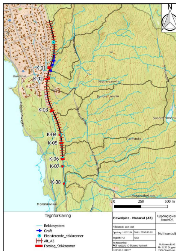
Figur 3-8. Plassering av stikkrenner og avskjærende overvannsgrøft.
