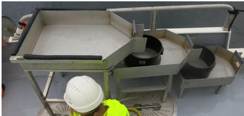
Figur 14. Sedimentet ble siktet gjennom sikter med 5 mm og 1 mm hull.
