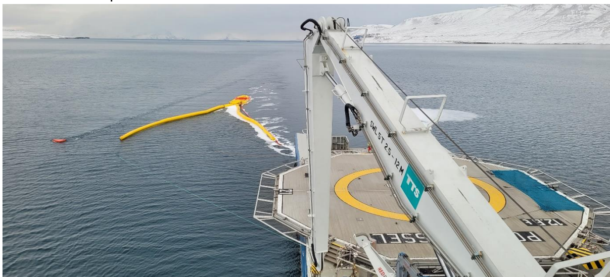
Current buster, oljeopptakersystem satt i drift fra Polarsysel. Innsatsmannskaper fra Svalbard betjener materiellet. Oljevernøvelse Grønfjorden, høst 2021.
